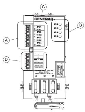
Figure 2-2. Smart A/C Module (SACM)
