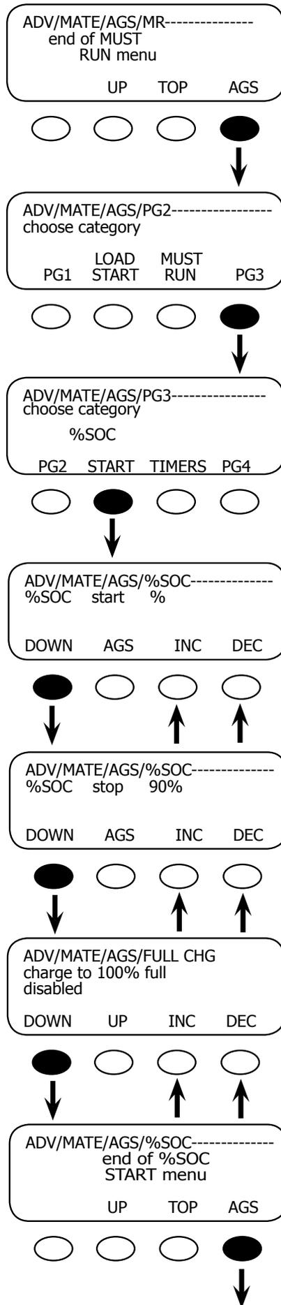
To proceed to the ADV/MATE/AGS/PG2 screen, press the <AGS> soft key
