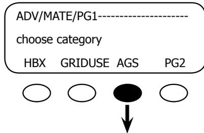
Go to the ADV/MATE screen and press the <AGS> soft key.
