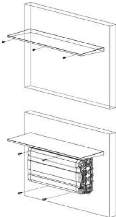
Fig. 6 : Wall mount step 1
