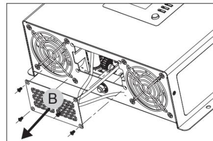
Retirez les quatre vis et détachez la plaque **B** du couvercle de l'ICDT de l'onduleur. Rangez les vis.
