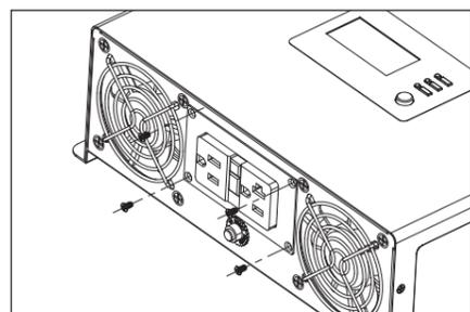
Fixez l'appareil ICDT à l'onduleur avec les quatre vis de l'étape 3.
