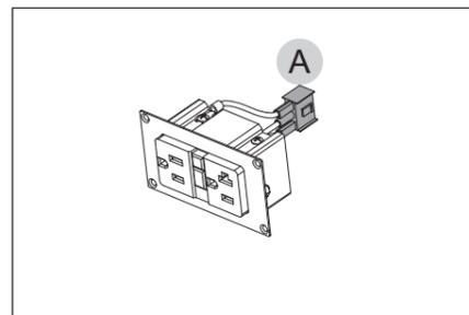
Retirez l'appareil ICDT de sa boîte. Il est livré avec un connecteur attaché **A**. Vous aurez besoin des outils suivants.
