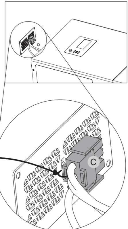
Couper le câble qui retient le connecteur ICDT **C** de l'appareil ICDT à la plaque du couvercle de l'ICDT **B**.
