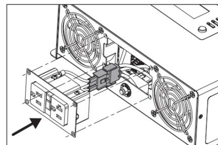
Montez l'appareil ICDT sur l'onduleur.
