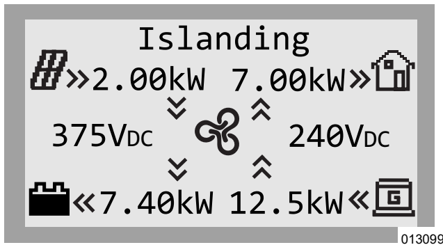
Figure 7-33. Modo Isla con generador de CA integrado
