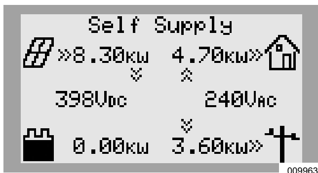
Figura 7-27. Self Supply (Autoabastecimiento) (2 de 3)
