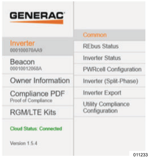
Figure 6-31. Vérifier le logiciel de l'onduleur
