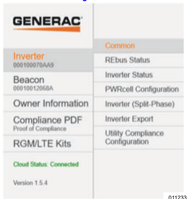
Figura 6-31. Verificación del software del inversor
