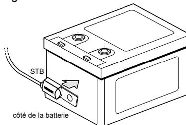
5. La surface sur laquelle le capteur doit être monté doit être plane et exempte de nervures de renfort ou d'autres éléments surélevés. Cette surface doit être en contact interne direct avec l'électrolyte de la batterie. N'installez pas le sonde près du haut de la batterie ou sur la surface supérieure de la batterie.
