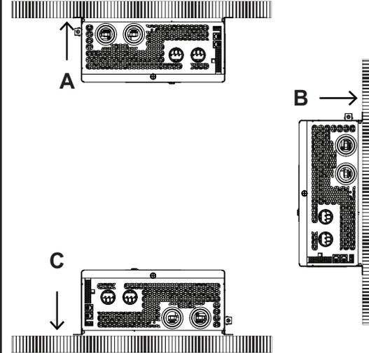
3. Marquez le nombre souhaité de trous de montage sur le mur en plaçant l'appareil sur le mur.
