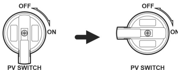
Figure 17 : Fonctionnement du déconnecteur PV
