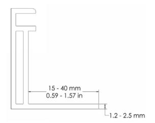
Compatibilidad del marco: Grosor del marco del módulo = 1.2 - 2.5 mm Ancho del marco del módulo = 15 - 40 mm
