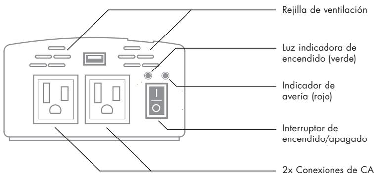
Interruptor de encendido/apagado – Controla el funcionamiento del inversor. Los indicadores siguientes funcionan con el interruptor encendido.
