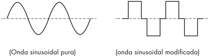
Esta onda sinusoidal modificada tiene una tensión de raíz cuadrada media (RMS) de 115 voltios. La mayoría de voltímetros CA habituales están calibrados para leer la tensión "media" y asumen que la forma de onda CA será una onda sinusoidal pura. Estos medidores no leerán correctamente la tensión MSW, y mostrarán aproximadamente entre 20 y 30 voltios menos. Cualquier multímetro identificado como "RMS AUTÉNTICO" leerá correctamente y con precisión la MSW.
