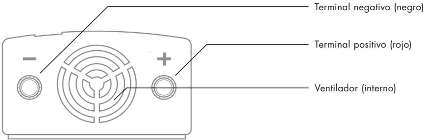
Ventilador de alta velocidad – El ventilador se enciende cuando hay una carga significativa o elevada temperatura para mantener frío el inversor. No lo obstruya. Mantenga 5 cm de espacio.
