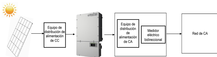
Figura 1.1 Sistema fotovoltaico interconectado a la red
