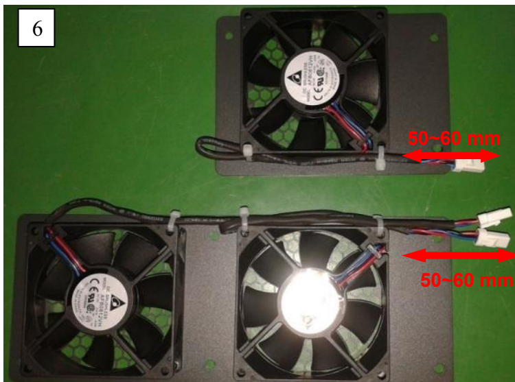
Figura 6.1 - Reemplazo de los ventiladores
