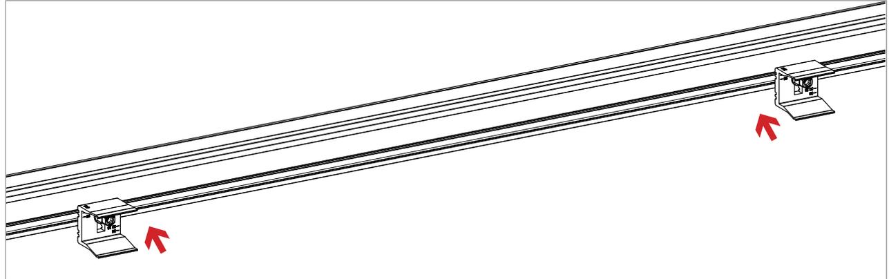
**INSTALL MODULE CLIPS ON TRIMRAIL:**
