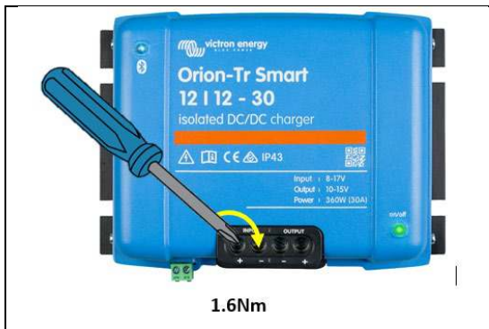
Ilustracja 6: Zalecany moment obrotowy
