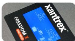
Affichage intégré du courant alternatif et batterie, de la barre d'état de la sortie de l'onduleur en %
